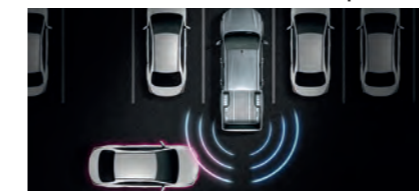
RCTA (Rear Cross Traffic Alert) ระบบช่วยเตือนขณะถอยรถ
